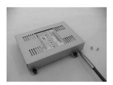
6. 内蔵HDDのHDDブラケットを元の場所に取り付けます。 HDDブラケットを取り付ける際の作業手順は、取り外したときの手順を逆にしたものです。製品底面の4つの取付け場所とHDDブラケットの取付け穴の位置をきちんと合せてから、ネジを留めます。
